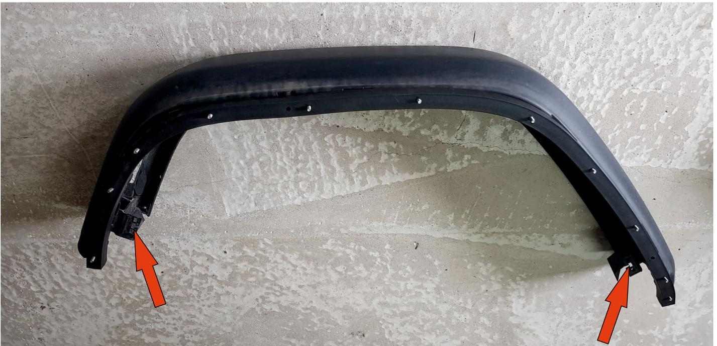
Kurze Gummistücke an den inneren Halteböcken einsetzen siehe rote Pfeile
